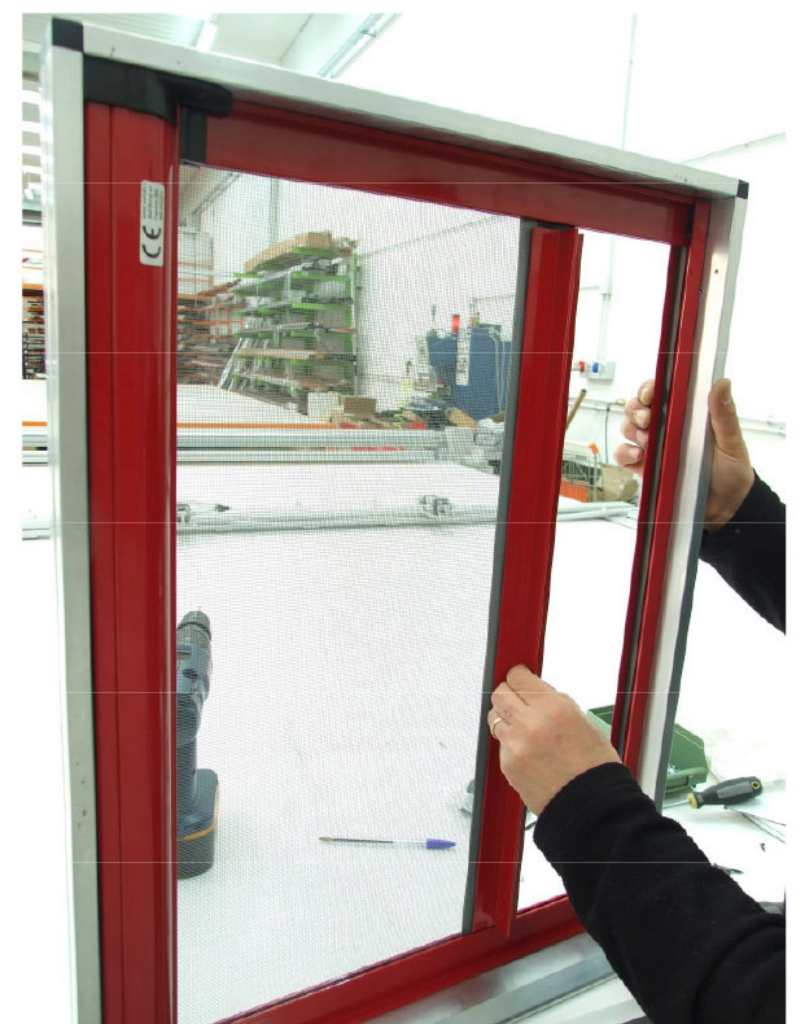
16 fissa la guida con tacchettino senza forare
