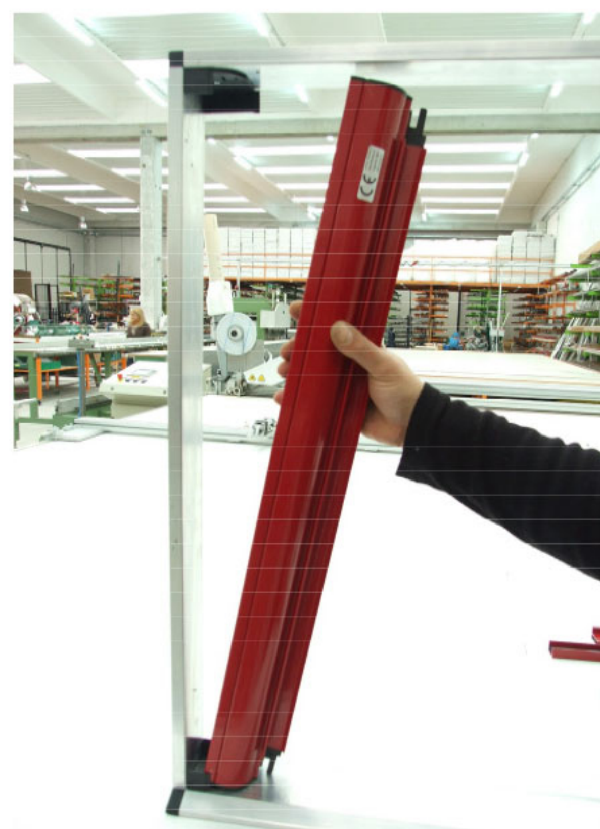
2 segnare per il foro superiore
