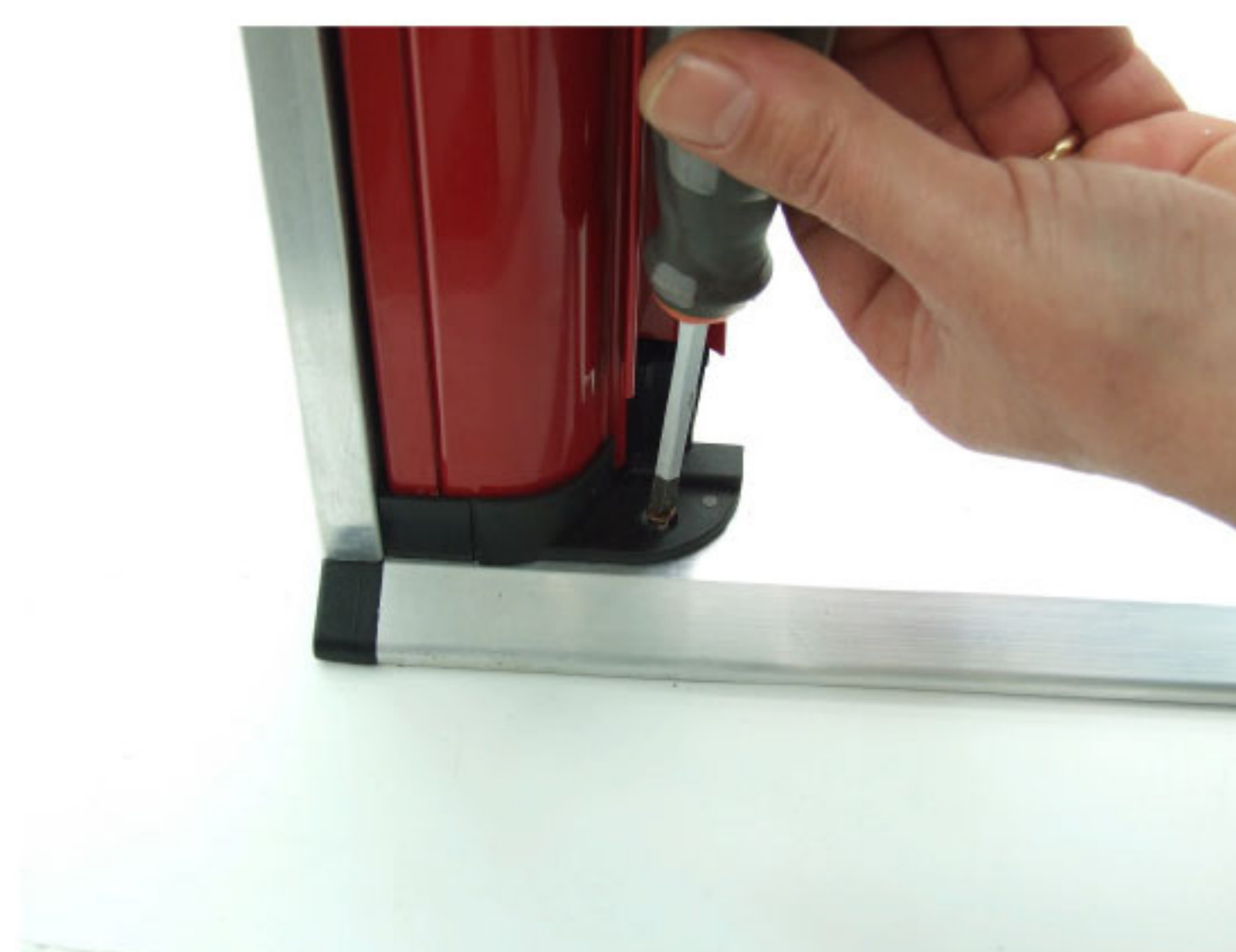
7 inserimento copri testata con fissaggio a vite
