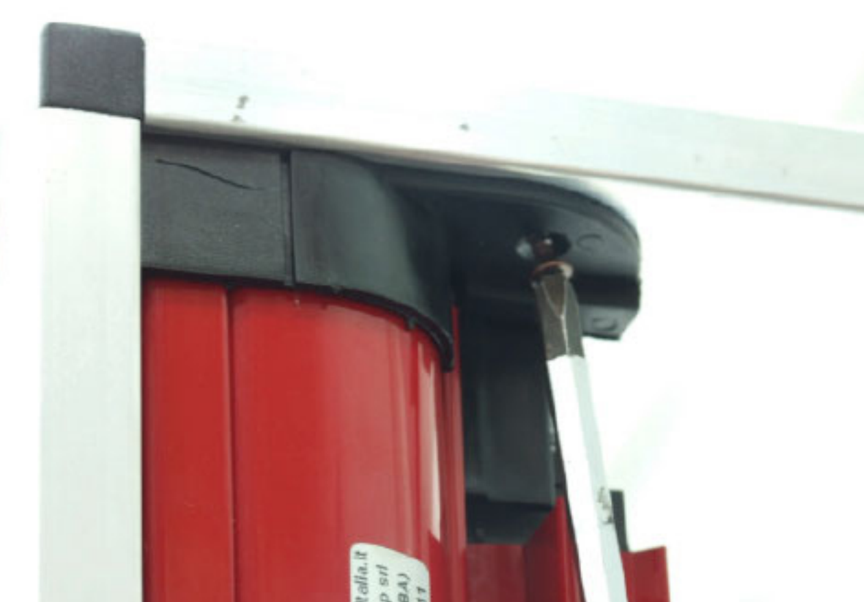
8 inserimento copri testata con fissaggio a vite
