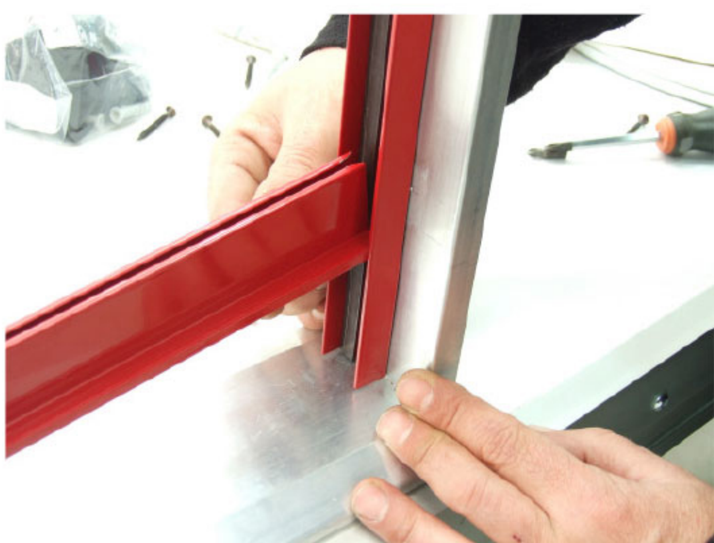
14 inserire guida inferiore nella guida laterale
