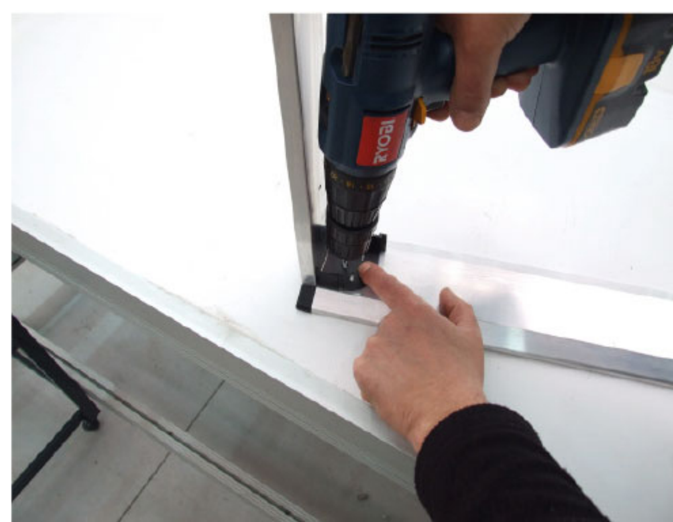
4 montaggio testata inferiore
