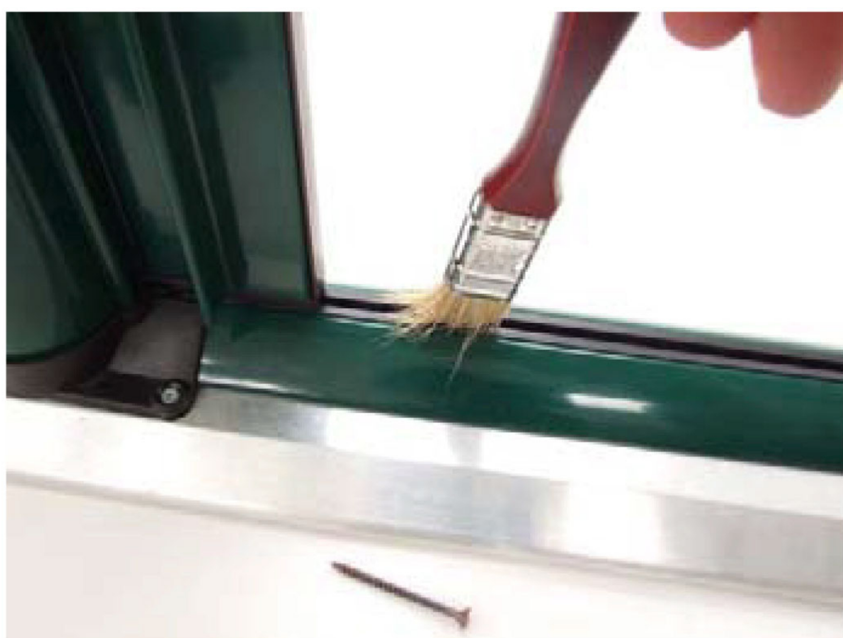
27° tenere sempre ben pulita l'interno della guida
